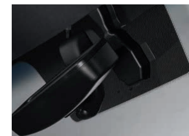
Predný kamerový modul s dažďovým senzorom a jednotkou pre automatické zapínanie diaľkových svetiel
